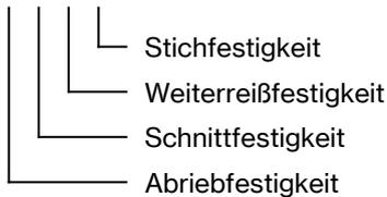
Piktogramm und Leistungsstufen nach EN 388 : 2003 (höchste Leistungsstufe: 4, bei Schnittfestigkeit: 5)
