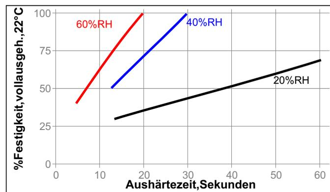
**Aushärtegeschwindigkeit in Abhängigkeit vom Aktivator**
