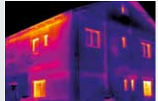
Energieverluste von Gebäuden aufspüren: Wärmebrücken an Fassaden oder im Gebäude sofort erkennen und abbilden.
