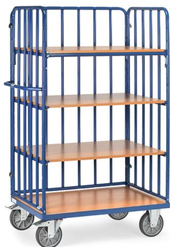
Ensemble mécano-soudé, revêtement époxy bleu RAL 5007. 1 plateau fixe et 3 amovibles en mélaminé surface effet hêtre. Ridelles avec tubes verticaux distancés de 130 mm. Plateaux amovibles réglables au pas de 100 mm. Charge maximum par plateau : 90 kg. 2 roues pivotantes et 2 roues fixes à bandage TPE, moyeu à roulement à billes central. Freins sur roues pivotantes conformément à la Norme 1757-3 (Sécurité des chariots de manutention).
