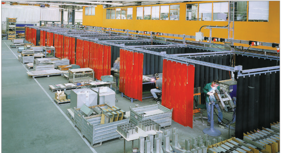
TransTac-System-Bauteile für Schutzvorhänge und Lamellen ermöglichen schnell und mühelos jede Art der Arbeitsplatzsicherung. Die Teile sind im Nu mit einfachen Klemmverbindungen montiert.
