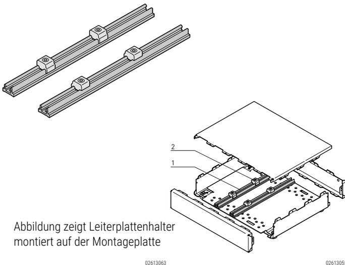
Abbildung zeigt Leiterplattenhalter montiert auf der Montageplatte
