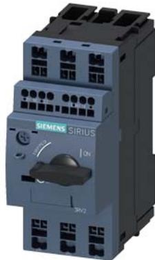
Leistungsschalter Baugröße S00 für den Motorschutz, CLASS 10 A-Auslöser 0,7...1 A N-Auslöser 13 A Federzuganschluss Standardschaltvermögen mit querliegenden Hilfsschalter 1S+1Ö
