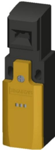
SICHERHEITS-POS. MIT GETRENNTM BETAETIGER,KUNSTSTOFFGEHAEUSE, 31MM; 1X(M20X1,5) SCHLEICHSCHALTGLIEDER 1S+2OE MIT 2 LEDS GELB/GRUEN 24V DC, 5 ANFAHRRICHTUNGEN, DER DAZU PASSENDE GETRENNTE BETAETIGER 3SE5000-0AV0. MUSS SEPARAT BESTELLT WERDEN
