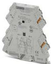
Fault-Monitoring-Modul mit steckbarer Anschlussstechnik zur Auswertung und Meldung der Sammelfehler des FM-Systems und zur Überwachung der Versorgungsspannungen. Fehlermeldung über Öffnerkontakt. Push-in-Anschlussstechnik, Standardkonfiguration
