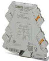
Konstantspannungsquelle mit steckbarer Anschluss technik zur Erzeugung einer hochpräzisen Konstantspannung von 15 V und zur Versorgung von Sensoren ohne eigene Versorgung. Push-in-Anschluss technik.
