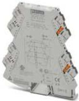
Einspeiseklemme mit steckbarer Anschlusstechnik zur Einspeisung der Versorgungsspannung auf den Tragschienen-Busverbinder. Überwachung der Versorgungsspannungen in Kombination mit dem Fault-Monitoring-Modul. Schraubanschlusstechnik
