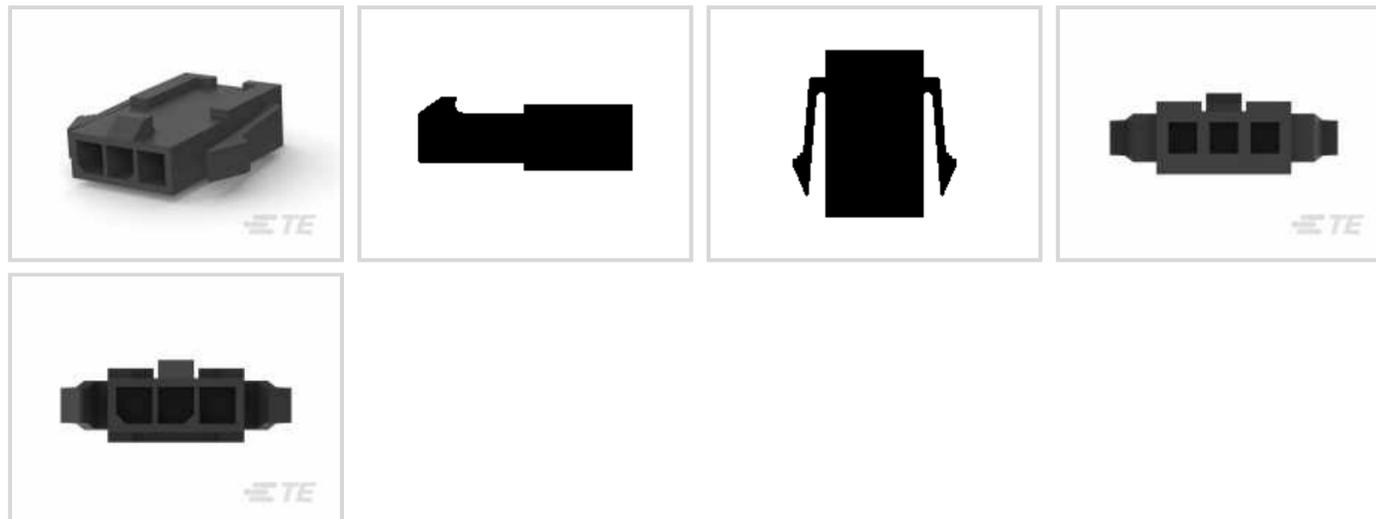
Rechteckiger Leistungssteckverbinderartyp: **Gehäuse**Steckverbinder- und Gehäusertyp: **Stecker**Steckverbindersystem: **Draht-an-Draht**Anzahl von Positionen: **3**Raster: **3 mm [ .118 in ]**
