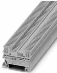
Durchgangsklemme, Strom und Spannung werden durch den eingesetzten Stecker bestimmt., Nennspannung: 500 V, Nennstrom: 17,5 A, Anschlussart: Steckanschluss, 1. Etage, Bemessungsquerschnitt: 1,5 mm<sup>2</sup>, Querschnitt: 0,14 mm<sup>2</sup> - 1,5 mm<sup>2</sup>, Montageart: NS 35/7,5, NS 35/15, Farbe: grau
