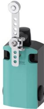
SIRIUS Positionsschalter Metallgehäuse XL, 56mm breit, mit Schwenkhebel, längenverstellbar mit Rasterbohrung, Edelstahlhebel, Edelstahlrolle 19mm, erhöhter Korrosionsschutz (EKS), Anschluss 3X(M20X1,5) vergoldete Kontakte: 2x(1S/1Ö) Sprungschaltglieder, Adapter 3SX5100-3B ( mit Zahnscheibe) beigelegt; Einsatz -40 Grad geeignet
