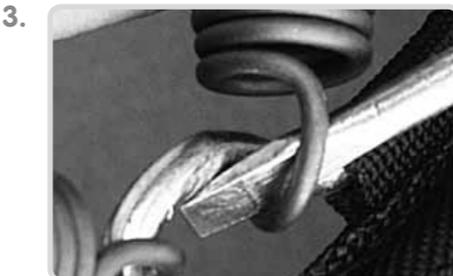
3. **Feder austauschen:** Eine Ersatzfeder zuerst am Rahmen einhängen. Dann das andere Ende mit einem Schlitz-Schraubenzieher durch Hebelwirkung in den Mattenbügel einhängen.
