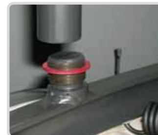
Den Sicherungsring ca. 2 Windungen auf den Stutzen drehen. Das Bein am Stutzen ansetzen und bis zum Ende des Stutzens aufschrauben.
