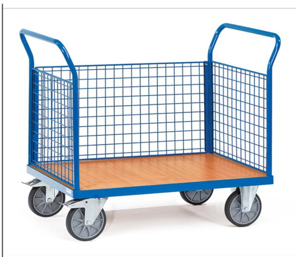
Ensemble mécano-soudé, revêtement époxy bleu RAL 5007, plateau en mélaminé surface effet hêtre avec 3 ridelles en treillis métallique 50 x 50 x 4 mm, hauteur petits et grand côtés 500 mm, grand côté boulonné. 2 roues pivotantes et 2 roues fixes à bandage TPE, moyeu à roulement à billes central. Freins sur roues pivotantes conformément à la Norme 1757-3 (Sécurité des chariots de manutention).
