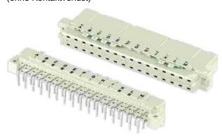
Zur Unverwechselbarkeit mehrerer Steckverbinder nebeneinander ist eine Kodierung erforderlich. Die Kodierung ist sowohl an der Messer- wie auch an den Federleiste fest angebracht. Die 12 Kodierstifte (Artikelnummer 09 02 000 9928) ermöglichen über 900 Kodiermöglichkeiten. Diese Stifte werden in das Steckverbinderoberteil und -unterteil eingerastet.
