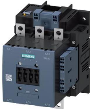
Leistungsschütz, AC-3 115 A, 55 kW / 400 V AC (50-60 Hz) / DC-Betätigung AC/DC 21-27, 3 V Hilfskontakte 2 NO + 2 NC 3-polig, Baugröße S6 Schienenanschlüsse Antrieb: elektronisch mit SPS-Schnittstelle DC 24 V Federzuganschluss
