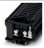
Sicherungsklemme für G-Sicherungseinsatz, Querschnitt: 0,5 - 16 mm², AWG: 26 - 8, Breite: 10,2 mm, Farbe: schwarz
