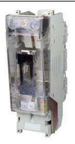
NH-SICHERUNGSUNTERTEIL GR.4A, 1-POLIG 1250A, 690V MIT FLACHANSCHLUSS
