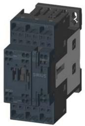
SCHUETZ, AC-3, 11KW/400V, 1S+10E, AC 110V 50/60HZ, 3POL, BGR. S0 FEDERZUGANSCHLUSS
