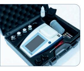
Tragbar im Koffer oder an einem festen Arbeitsplatz: Das Trübungsmessgerät TB350 ist ideal für den mobilen Einsatz vor Ort, z. B. für die Überwachung von Wasserverteilungssystemen, und für Labore, die eine Vielzahl von Proben untersuchen.
