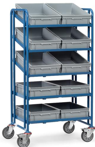
Ensemble mécano-soudé et vissé, revêtement époxy bleu RAL 5007. Plateaux amovibles dans supports réglables au pas de 100mm, inclinaison de 15° et 30°. Charge par plateau 80 kg. 5 niveaux avec 10 bacs euro 600 x 400 x 145 mm. 4 roues pivotantes à bandage TPE, moyeu à roulement à billes central. Freins sur roues pivotantes conformément à la norme européenne EN 1757-3.
