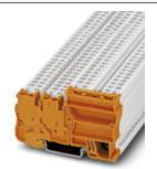
Einspeiseklemme, Anschlussart: Zugfederanschluss, Querschnitt: 0,08 mm² - 4 mm², AWG: 28 - 12, Breite: 10,4 mm, Farbe: orange, Montageart: NS 35/7,5, NS 35/15
