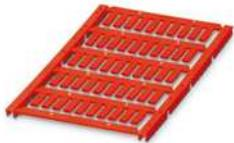
Leitermarker, Matte, rot, unbeschriftet, beschriftbar mit: TOPMARK NEO, TOPMARK LASER, BLUEMARK ID COLOR, BLUEMARK ID, BLUEMARK CLED, THERMOMARK PRIME, THERMOMARK CARD 2.0, THERMOMARK CARD, Montageart: einschieben, Kabeldurchmesserbereich: 0,6 ... 10 mm, Schriftfeldgröße: 12 x 4 mm, Anzahl der Einzelschilder: 50
