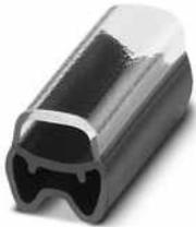
Ader-Bezeichnungsträger, transparent/schwarz, unbeschriftet, Montageart: aufschieben, Kabeldurchmesserbereich: 1,3 ... 2,8 mm, Schriftfeldgröße: 12 x 4 mm
