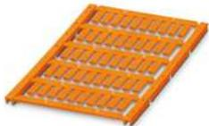
Leitermarker, Matte, orange, unbeschriftet, beschriftbar mit: TOPMARK NEO, TOPMARK LASER, BLUEMARK ID COLOR, BLUEMARK ID, BLUEMARK CLED, THERMOMARK PRIME, THERMOMARK CARD 2.0, THERMOMARK CARD, Montageart: einschieben, Kabeldurchmesserbereich: 0,6 ... 10 mm, Schriftfeldgröße: 12 x 4 mm, Anzahl der Einzelschilder: 50
