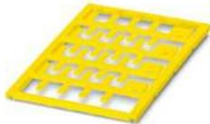
Kabelmarker, Matte, gelb, unbeschriftet, beschriftbar mit: BLUEMARK ID COLOR, BLUEMARK ID, BLUEMARK CLED, PLOTMARK, CMS-P1-PLOTTER, Montageart: einschieben, Kabeldurchmesserbereich: 0,6 ... 10 mm, Schriftfeldgröße: 12 x 4 mm, Anzahl der Einzelschilder: 32
