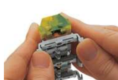
Klemmenleiste mit Rastfüßen Anrasten des Montagefußes (209-120) (Der Abstand der Montagefüße zueinander unter einer Klemmenleiste soll ca. 25 ... 30 mm betragen.)
