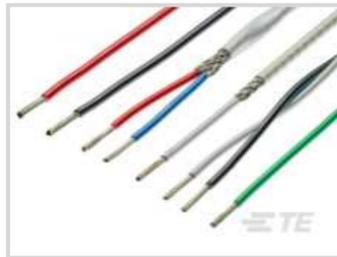
Kabeltyp: **Spec 44**Nennspannung: **600 V**Isoliermaterial für Leitungen und Kabel: **Strahlvernetztes modifiziertes PVDF**Leitermaterial: **Zinnbeschichtetes Kupfer**Drahtgröße: **26 AWG**
