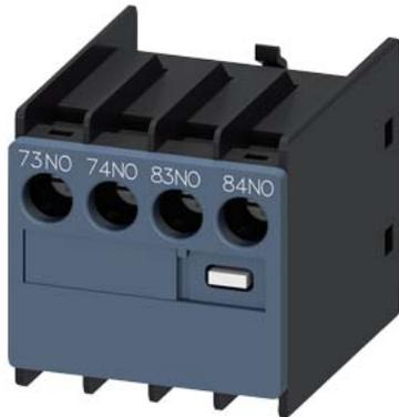
Hilfsschalter frontseitig, 2 S Strombahn 1 S, 1 S Anschluss von oben für 3RH2 und 3RT2 Schraubanschluss 73/74, 83/84
