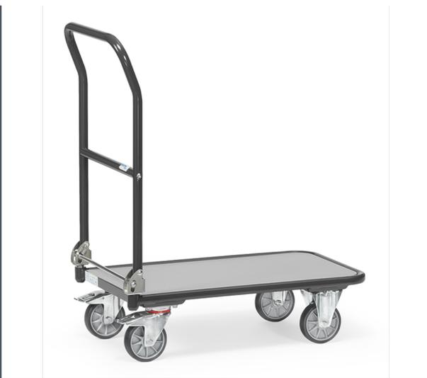
Klappwagen aus Stahlrohr, pulverbeschichtet anthrazitgrau RAL 7016. Ladefläche aus Holzwerkstoffplatte, Oberfläche mittelgrau. Schiebebügel auf Plattform klappbar. 2 Lenk- und 2 Bockrollen, TPE-Bereifung (spurlos), Naben mit Rillenkugellager. Feststeller an den Lenkrollen, gemäß der Europäischen Norm EN 1757-3 (Sicherheit von Plattformwagen).
