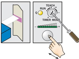
Drehschalter auf Position „+“ drehen und Teach-in-Knopf drücken, bis gelbe LED leuchtet (an der Balkenanzeige gehen mehr grüne LEDs an).
