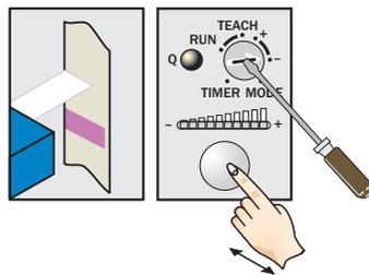
Sollte gelbe LED leuchten, Drehschalter auf Position „-“ drehen und Teach-in-Knopf drücken, bis gelbe LED gerade erlischt (an der Balkenanzeige gehen grüne LEDs aus).
