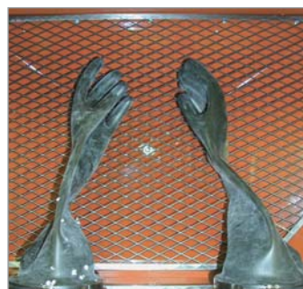
Integrierte Schutzhandschuhe aus flexiblem Kunststoff
