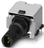
SPE-Leiterplatten-Steckverbinder, Bauform: IEC 63171-5, Schutzart: IP65/IP67, Polzahl: 2, CAT B (ISO/IEC 63171), Material: Metall, Anschlussart: THR-Lötanschluss, Single Pair Ethernet
