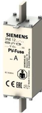
PV-Sicherungseinsatz, mit Messerkontakten, NH1XL, In: 100 A, gPV, Un DC: 1500 V, Stirnkennmelder
