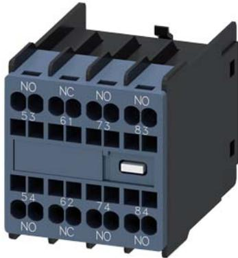
Hilfsschalter, frontseitig, 3 S + 1 Ö, 53/54 , 61/62 , 73/74 , 83/84, Strombahn: 1 S, 1 Ö, 1 S, 1 S, Federzuganschluss, physisch kodiert, nur mit Hilfsschützen 3RH2140 und 3RH2440 kombinierbar (nach EN 50011)
