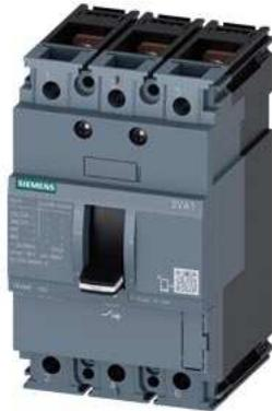
Leistungsschalter 3VA1 IEC Frame 160 Schaltvermögenklasse M Icu=55kA @ 415V 3-polig, Starterschutz TM110M, FM, In=12,5A ohne Überlastschutz Kurzschlusschutz Ii=15 x In Schraubenflachanschluss
