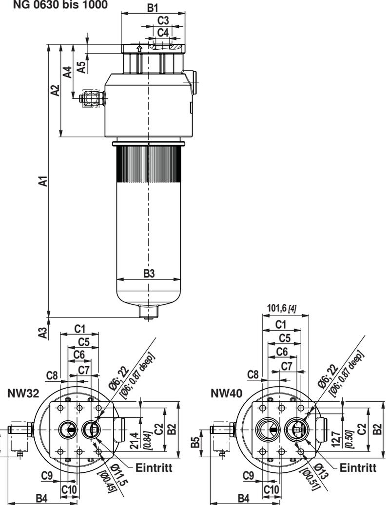
Filtergehäuse für Filterelemente
