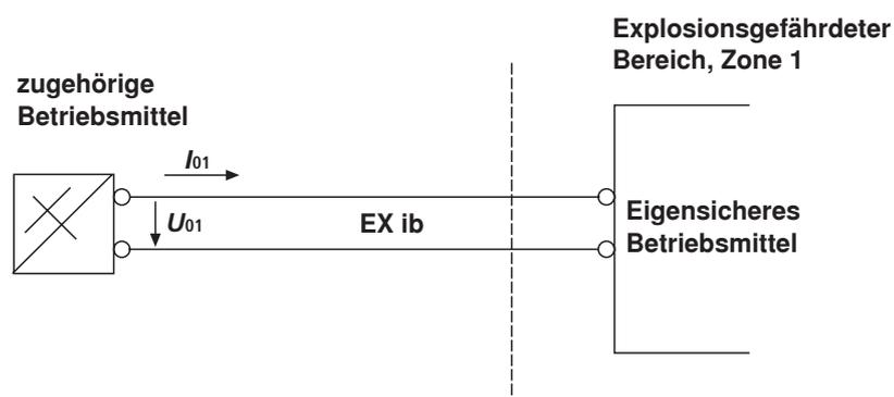
Bei elektrischen Wartungsanzeigen mit zwei Schaltpunkten müssen Schaltgeräte mit zwei eigensicheren Eingangskreisen verwendet werden.
