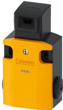
Sicherheits-Positionsschalter mit getrenntem Betätiger Metallgehäuse, 56 mm Geräteanschluss 3x (M20x 1,5) Schleifschaltglieder 1S/2Ö mit 2 LEDs, DC 24 V gelb/grün 5 Anfahrrichtungen der dazu passende getrennte Betätiger 3SE5000-0AV0. muss separat bestellt werden
