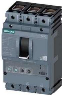
Leistungsschalter 3VA2 IEC Frame 100 Schaltvermögenklasse C Icu=110kA @ 415V 3-polig, Anlagenschutz ETU350, LSI, In=63A Überlastschutz Ir=25A...63A Kurzschlusschutz Isd=1,5...10 x Ir, li=12 x In Klemmenanschluss
