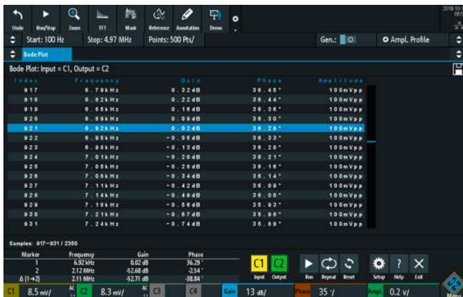
Eine Messergebnistabelle liefert detaillierte Informationen zu jedem Messpunkt, bestehend aus Frequenz, Verstärkung und Phasenverschiebung
