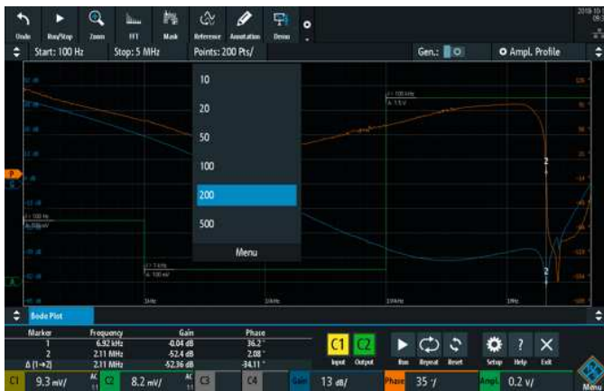
Die Messauflösung ist durch Änderung der Punkte pro Dekade anpassbar
