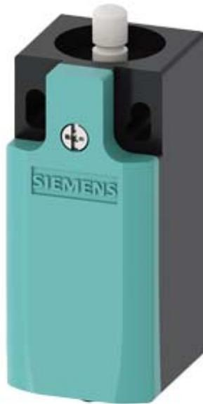
Positionsschalter mit Kunststoffgehäuse Schaltschranktyp ohne Montageplatte DIN EN 50047, 1 x (M20 x 1,5) integriert (nicht austauschbar) Kuppenstößel Schutzart IP40, mit Würfenippel Standard-Deckel in türkis ohne Verriegelungsblech, ohne Dichtung, ohne Schrauben
