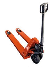
Rollen: - Einfachrolle mit Kletterrolle: bei ebenem Boden, bei Paletten-Queraufnahme, beim Rangieren auf engem Raum 10 bzw. 12 Schmiernippel für eine hohe Lebensdauer Nennkraft: 2300 kg Reduzierte Nenntragfähigkeit: 2000 kg Hubhöhe: 200 mm Ma ss über die Gabel: 520 mm Gabelbreite: 156 mm Gabellänge 800 oder 1150 mm Gabelhöhe im gesenkten Zustand: 85 mm Lenkrollendurchmesser: 175 mm Lenkrollenbreite: 60 mm Gewicht: ca. 65 kg Garantie: 5 Jahre (ausgenommen Verschlei ssteile) Farbe: Rot
