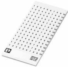
Kennzeichnungskarte, weiß, beschriftet, längs: fortlaufende Zahlen 1 ... 10, 11 ... 20 usw. bis 91 ... (99)100, Montageart: kleben, für Klemmenbreite: 3,81 mm, Schriftfeldgröße: 3,81 x 2,8 mm
