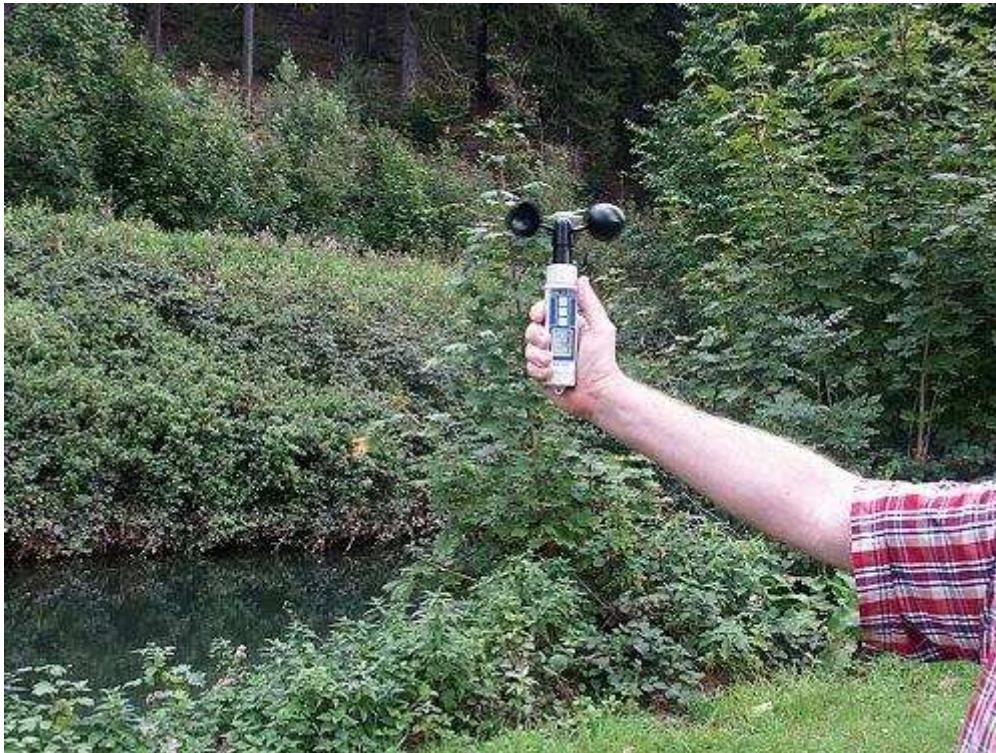
Eine Windmessung mit dem Schalenkreuz-Anemometer PCE-A 420
