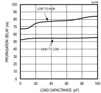
**RECEIVER 2 PROPAGATIONDELAY** vs. LOAD CAPACITANCE
