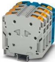
Hochstromklemme, geblockt, Nennspannung: 1000 V, Nennstrom: 150 A, Anschlussart: PowerTurn-Anschluss, 1. Etage, Querschnitt: 10 mm<sup>2</sup> - 70 mm<sup>2</sup>, Montageart: NS 35/15, Farbe: grau/blau
