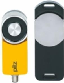
Magnetisches, sicheres Schutztürsystem für Anwendungen bis SIL 3/ PL e/Kat. 4. Magnetische Haltekraft 500 N (Prozessschutz). Codierung: vollcodiert, Teach-in von weiteren Betätigern möglich (insgesamt 8 mal), Zusatzfunktion: Sichere Halbleiterausgänge schalten bei geschlossener Türe (unabhängig von der Zuhaltung), 8-pol. M12 Stecker, 4 LEDs, IP67, Verpackungsinhalt = Sensor mit Standard-Betätiger
