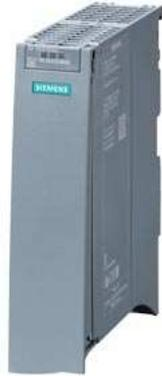
SIMATIC ET 200MP PROFINET IO-Device Interfacemodul IM 155-5 PN BA für ET 200MP Elektronikmodule; bis zu 12 IO-Module; integrierter 2Port-Switch; RJ45 Shared Device an 2 IO Controllern; MRP; FW-Update; I&M0...3
