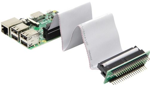
Mit diesem Cobbler- / Verbindungskit können Sie den Raspberry Pi mit weiteren und selbst gebauten Platinen verbinden.
