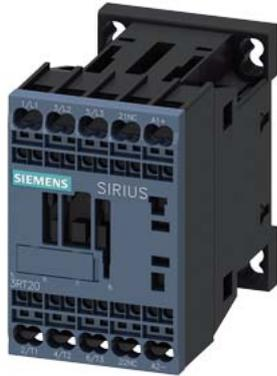
Leistungsschütz, AC-3 12 A, 5,5 kW / 400 V 1 Ö, DC 24 V 0,85-1,85\* US, mit Suppressordiode integriert Baugröße S00, Federzuganschluss
