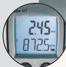
Der Volumenstrom wird direkt im großen Display angezeigt
