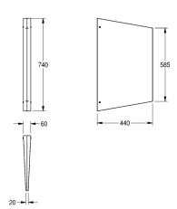
Urinaltrennwand für Aufputzmontage, Chromnickelstahl, Oberfläche seidenmatt, Materialstärke 2,0 mm, in Struktur WL5 1,0 mm, verdeckte Wandmontage, inklusive Befestigungsmaterial.
