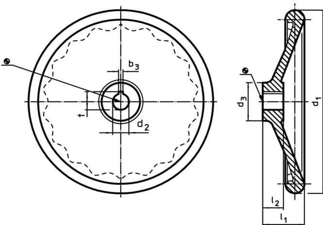
L'orientation de la rainure de clavette peut être différente de celle représentée sur le dessin.
